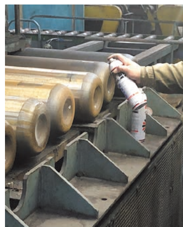
気密試験 Leakage Test
