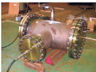
水圧試験 Hydrostatic Test
